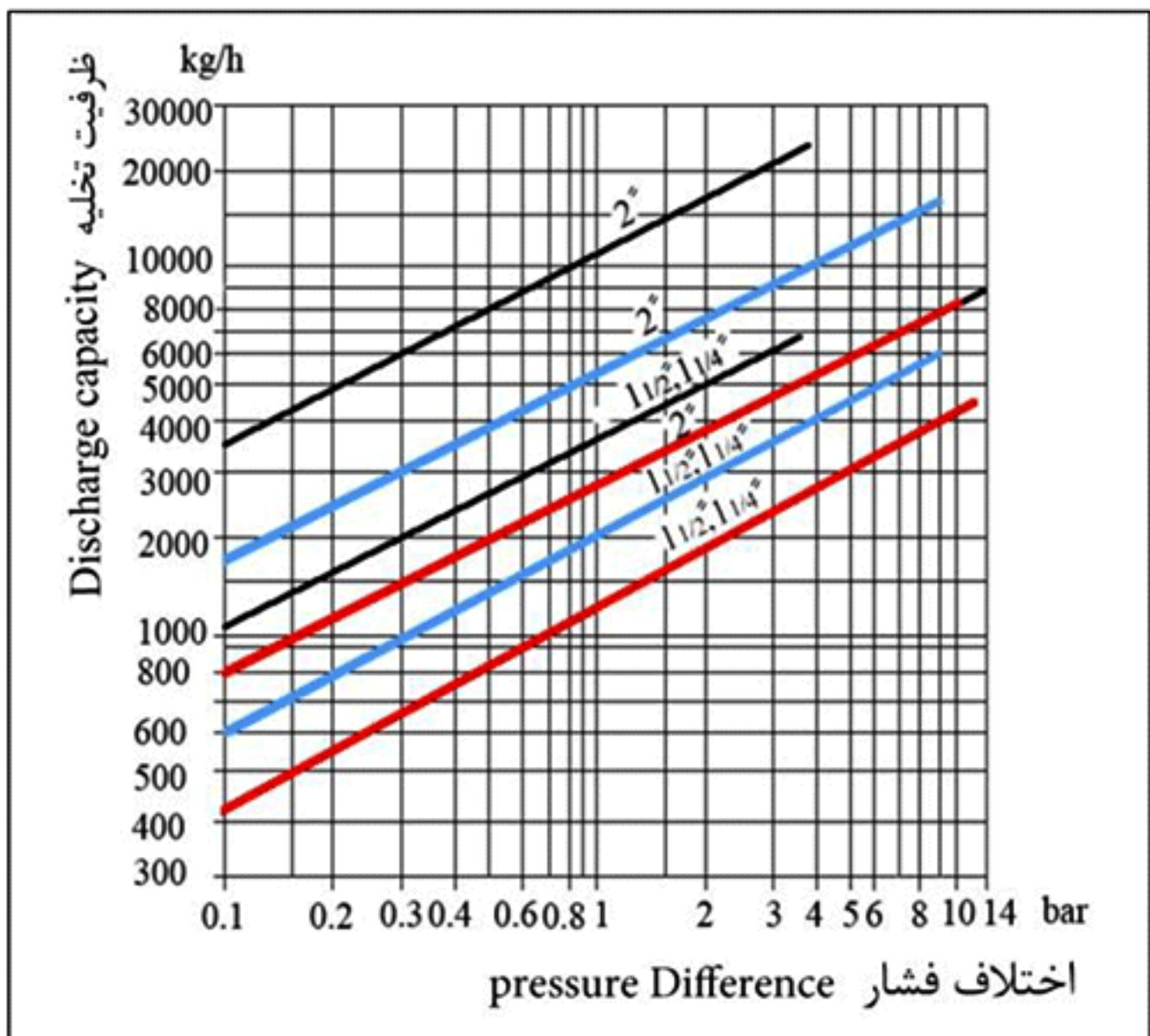
در نمودار مقابل با توجه به اختلاف فشار ، ظرفیت تخلیه مشخص شده است که منحنی قرمز برای اختلاف فشار ۱۴ بار، منحنی آبی برای اختلاف فشار ۱۰ بار و منحنی سیاه برای اختلاف فشار ۴.۵ بار می باشد .
